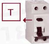
2. ส่วนในเครื่องตัดไฟรั่วนั้นจะมีปุ่มกด หรือ อาจระบุ ว่า Monthly Trip หรือ แถบสีส้ม หมายถึง การจำลองทดสอบกระแสไฟรั่วทุกเดือน เพื่อให้ระบบกลไกทำงานเป็นปกติ และเป็นการป้องกันมด และปลวกเข้าไปทำรังอยู่ซึ่งมีอากาศที่อบอุ่น
